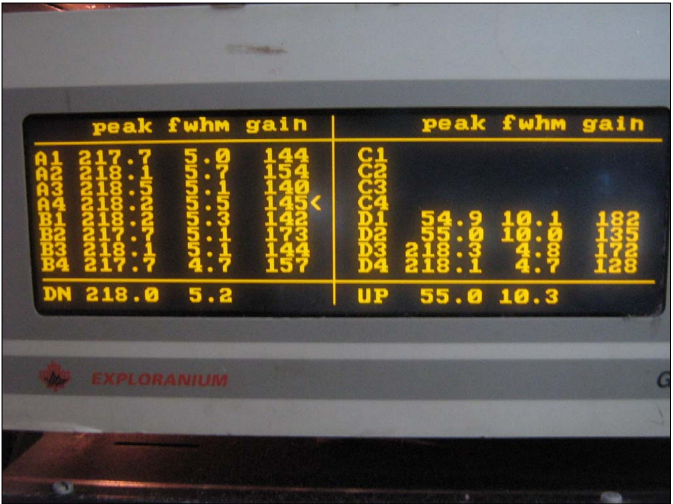
Foto tirada no dia 28/03/2007 no hangar em Jacarepaguá mostrando a resolução dos cristais do sistema Exploranium GR820 da aeronave PT-FZN.
