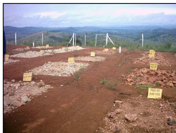
Figura 8.8: Testemunhos dos furos de sondagem do projeto Mirabela Saprólito.
