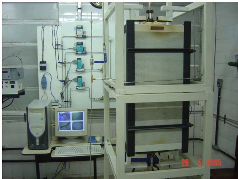
Figura 14: Vista do forno com o reator de leito fixo e do sistema de alimentação com os controladores de vazão de gás.
