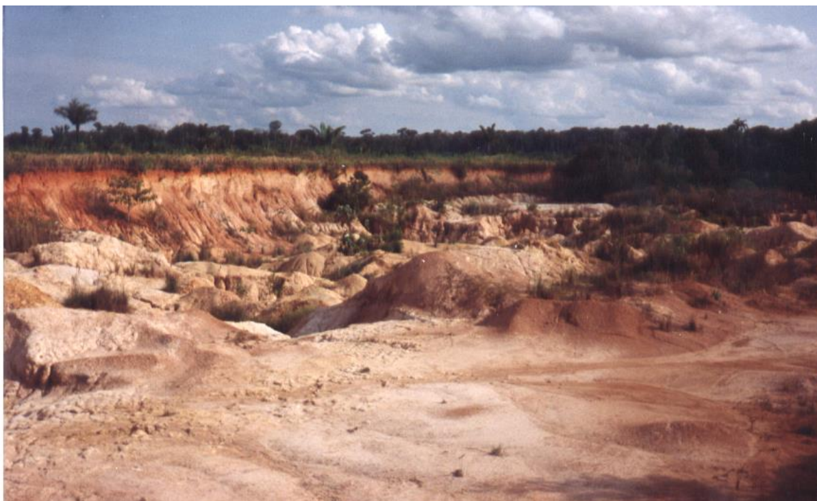
Foto 7: Aspecto geral de uma cava abandonada. Nota-se a pequena espessura do Horizonte B do solo, o relevo plano e a pequena profundidade das cavas, em torno de 4 metros.
