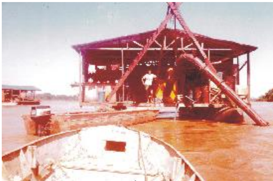
Figura 14 – Dragas em operação no rio Madeira – extração de ouro aluvionar, atividade que desagrega grande quantidade de material do leito e das margens do rio, aumentando a carga de sólidos em suspensão, que contribuem de forma efetiva para o processo de assoreamento.
