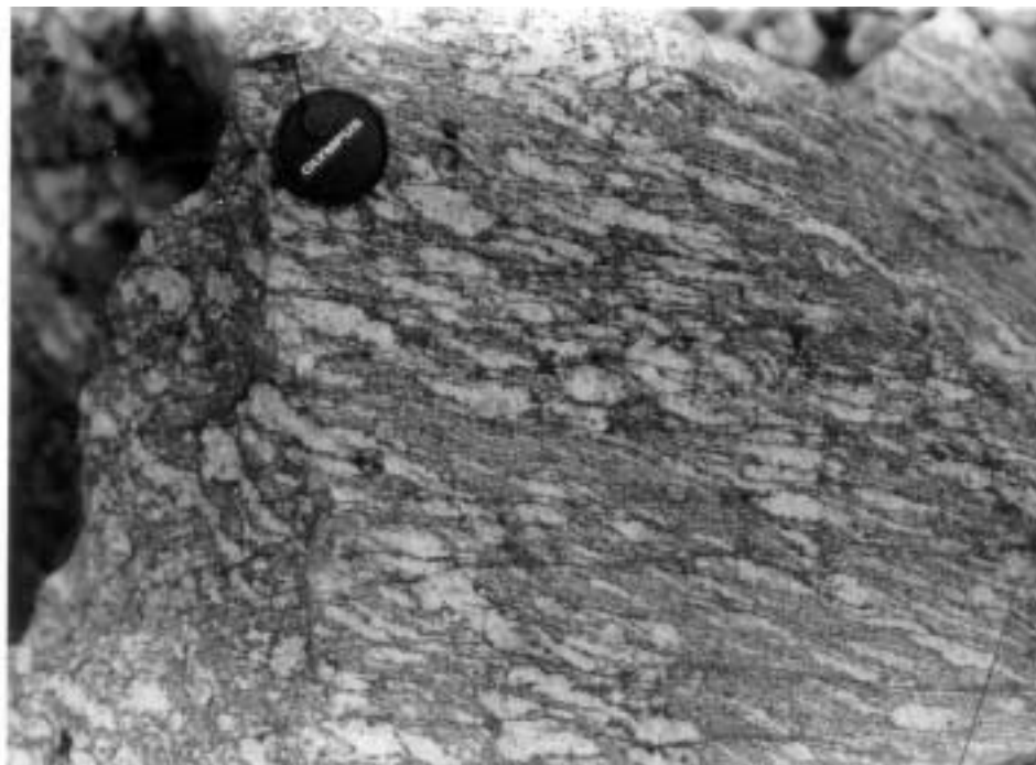
Figura 6.10. Faixas de cisalhamento delgadas oblíquas ao bandamento gnáissico S_n . Ortognaisse Serra do Quiabeiro. Granodiorito gnaisse ocelar-porfiroclástico. Afloramento 84.
