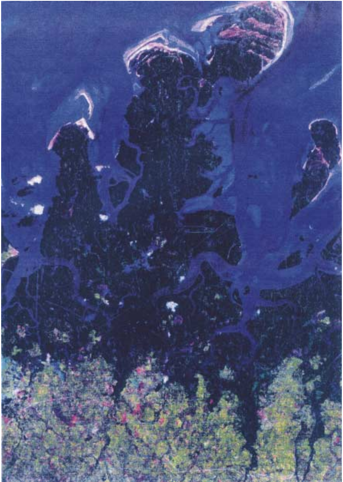
FOTO 7.01 - Foto Landsat TM mostrando os principais rios e a orla marítima na cor azulada, as praias na cor branca, os mangues na cor escura, as florestas na cor amarelo-esverdeada e os desmatamentos na cor avermelhada. Escala 1:100.000
