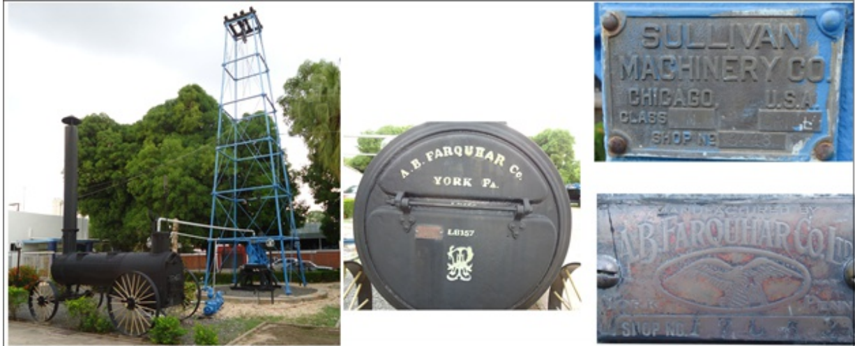
Figura 4: Vista geral da sonda de perfuração de poços, movida a vapor situada na Unidade Regional da CPRM de Teresina-Piauí. No detalhe, as placas de identificação inseridas em sua estrutura.
