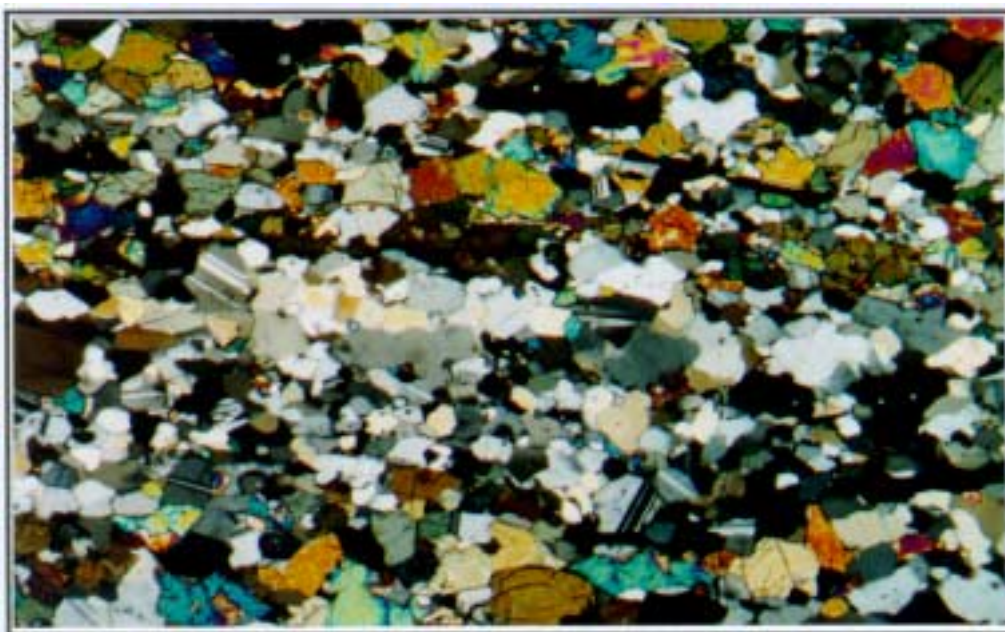
Figura 50- Bandamento metamórfico regular definido por níveis de minerais máficos e félsicos refletindo, provavelmente, o acamamento primário. Fotomicrografia à luz polarizada. Dimensões do campo = 1,8mm x 2,7mm.
