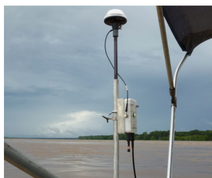
(d) DGPS – Instalado na embarcação.
