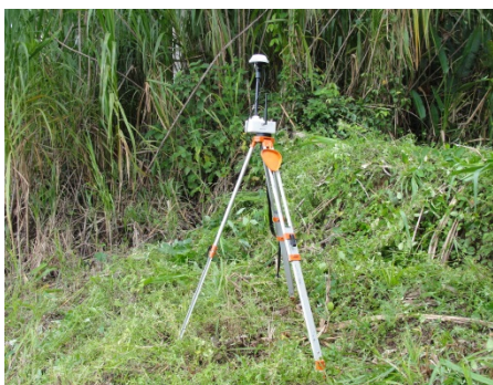
(c) GPS-RTK instalado na margem do rio.
