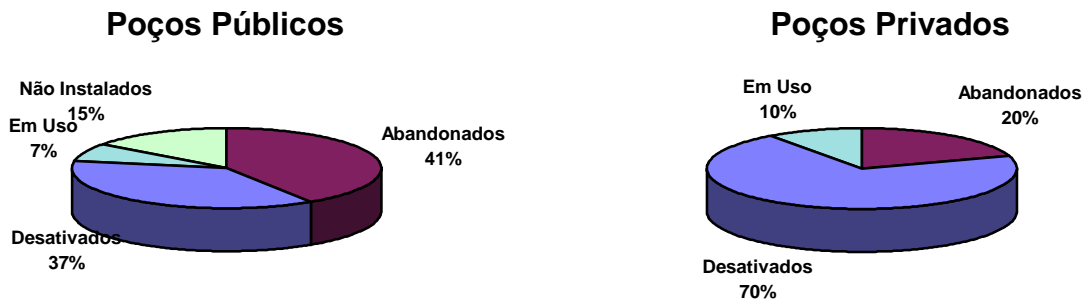
Figura 3.2 – Situação atual dos poços tubulares cadastrados.
