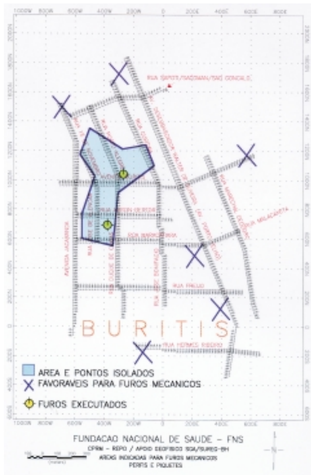
Figura 13 - Planta da área urbana de Buritis com indicação de área para perfuração de poços tubulares.
