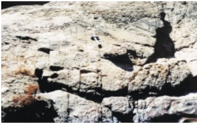
Foto 3 - Rocha granítica na região de Buritis apresentando direções variadas de fraturamento.
