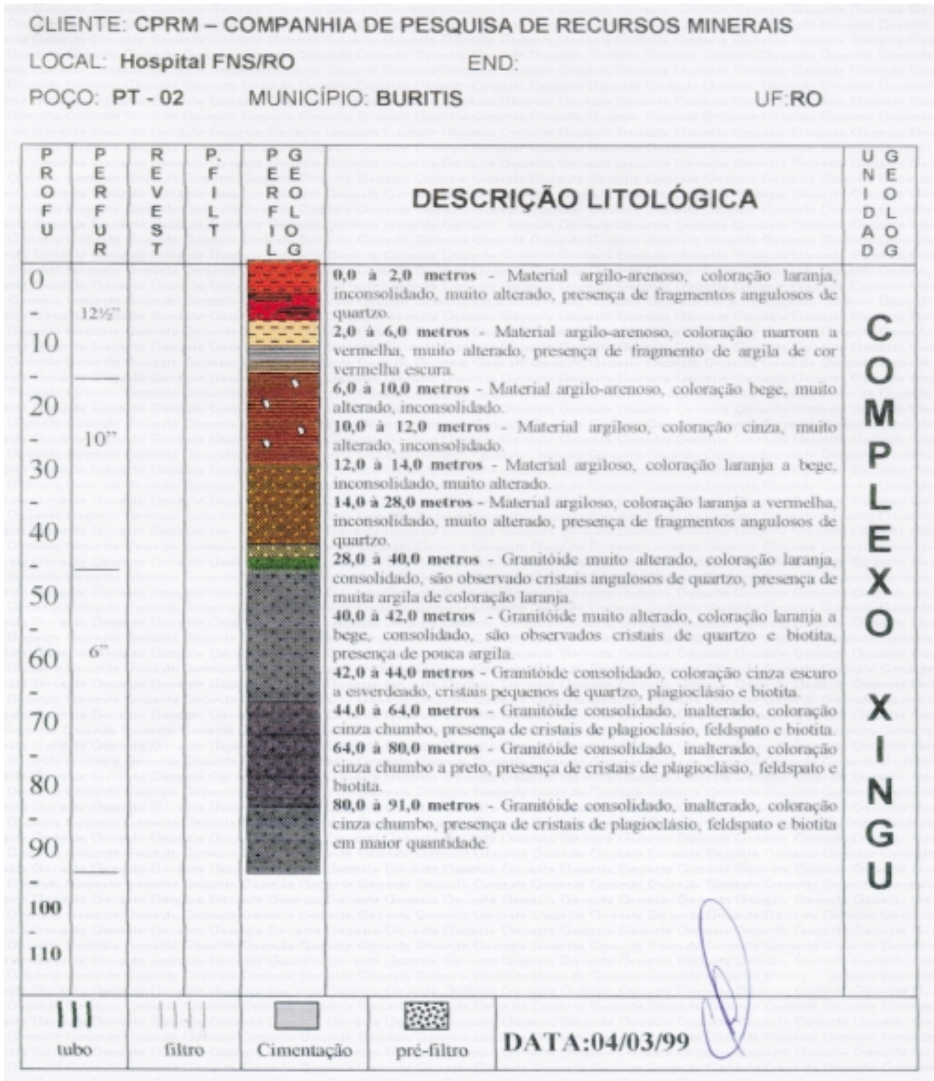
Figura 16 - Perfil litológico do poço perfurado Pt02
