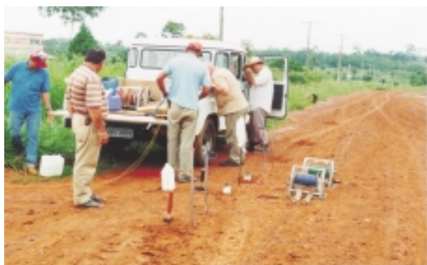
Foto 5 - Equipe de geofísica se preparando para execução de Sondagem Elétrica Vertical na área urbana de Nova Califórnia.
