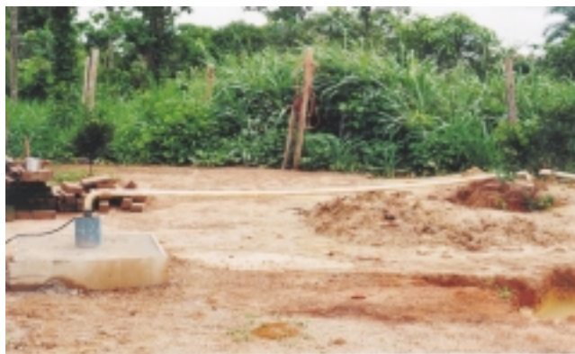
Foto 4 - Poço da RECA sendo bombeado durante o teste de produção.
