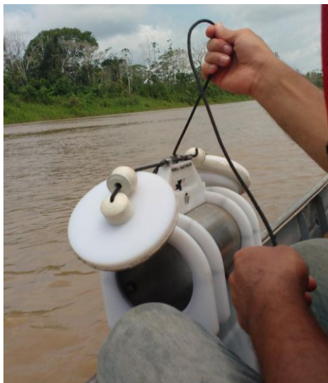
Figura 3. Amostrador pontual para a amostragem de sedimentos em suspensão.
