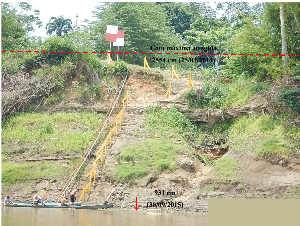
Figura 2. Foto ilustrativa da estação fluviométrica de Abunã (Réguas limnétricas e seção de medição de descarga líquida) com destaque para a cota máxima já atingida na localidade.
