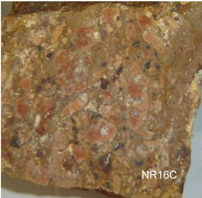
Figura 17 - Fragmentos de rocha vulcânica félsica com fenocristais argilizados de feldspato (tufo de cristais)
