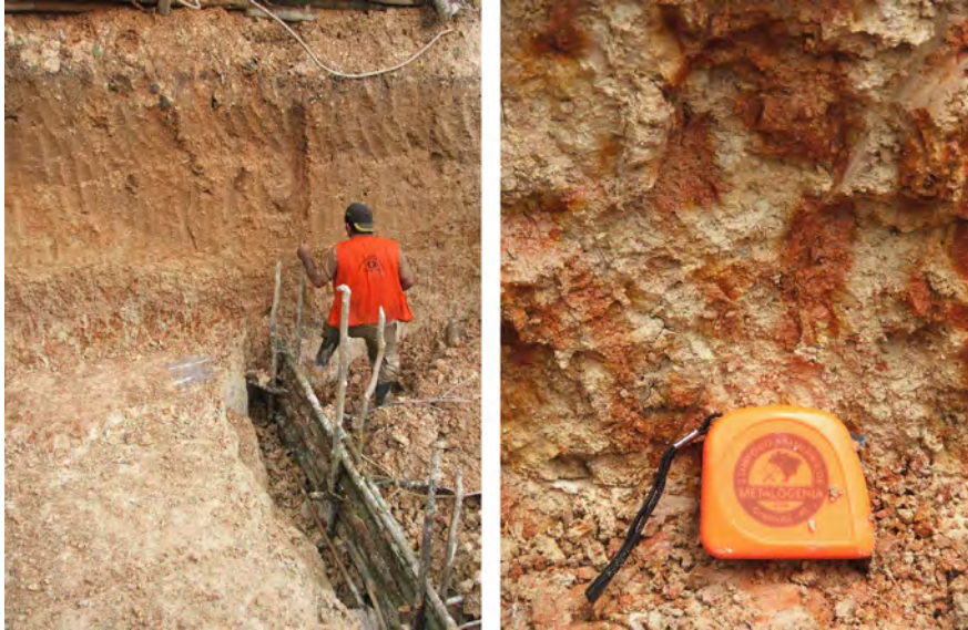
Figura 9 – Perfil laterítico sobre as rochas da Grotta Rica, com detalhe do horizonte mosqueado.
