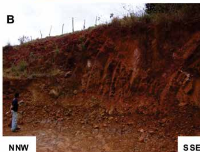
Figura 4.6 - A: falha de escala métrica, ponto V-540; B: diáclases bem desenvolvidas em anfibolito, ponto V-661; C: diagrama de roseta da direção dos planos de fratura, 44 medidas, com pétalas dominantes: N45E, N75W e N55W
