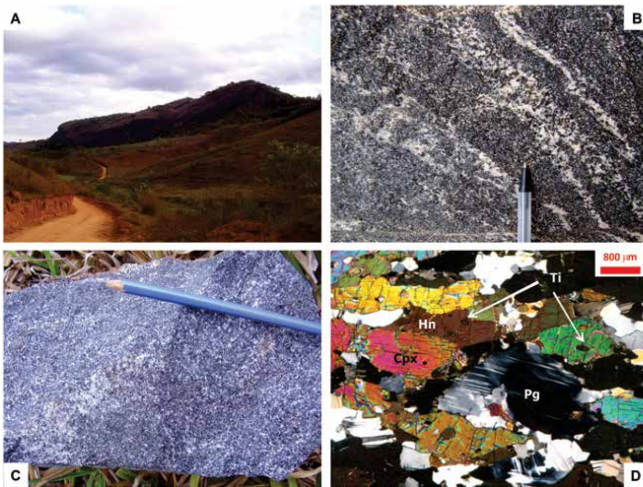
Figura 3.13 A: corpo de anfibolito alongado destacando em meio ao terreno arrasado do ortognaisse Mantiqueira, ponto V-594; detalhe do anfibolito com bandado (B) e apenas foliado (C), pontos V-594 e V-661, respectivamente; D: fotomicrografia apresentando mineralogia típica, com hornblenda (Hn), plagioclásio (Pg), clinopiroxênio (Cpx) e titanita (Ti), ponto V-594
