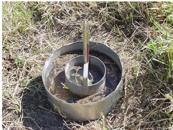
Figura 4 – Infiltrômetro de duplo-anel
