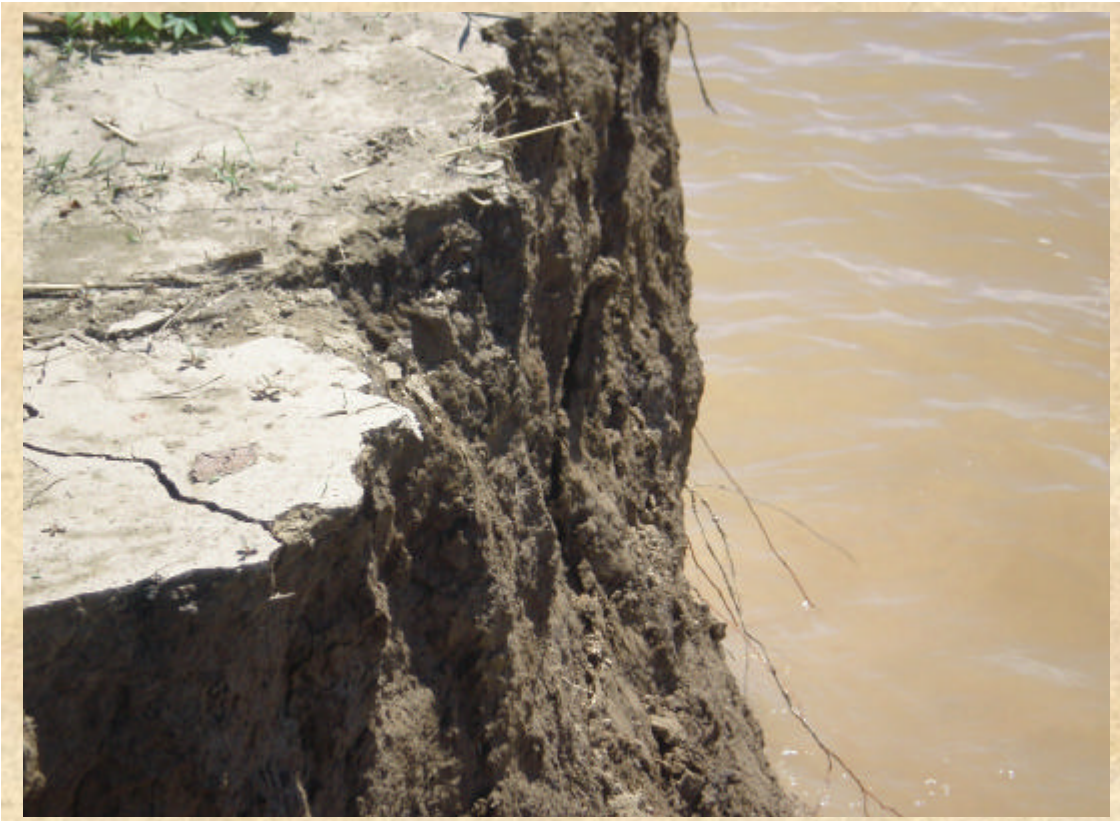
Foto 02 – Afloramento da borda oeste da área afetada, com espessura aproximada de 2,5 metros, mostrando a fragilidade do solo.
