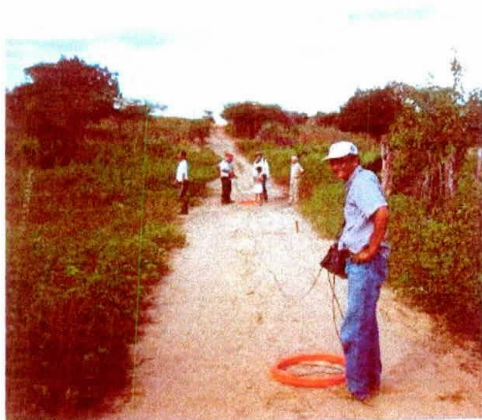
Figura 8: Foto mostrando a aquisição através de dipolo magnético vertical
