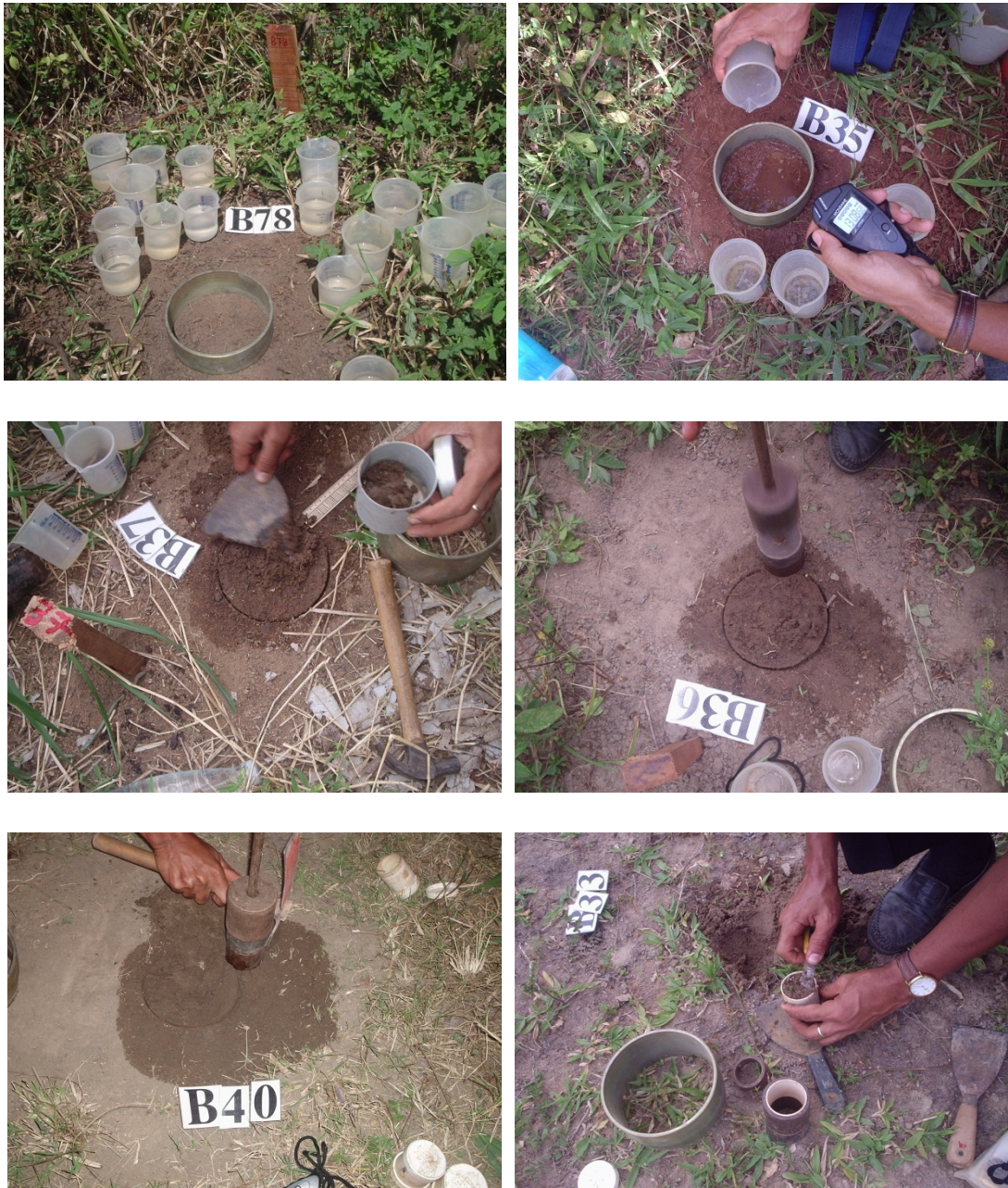
Figura 3.10 – Teste de infiltração tridimensional com infiltrômetro de anel.
