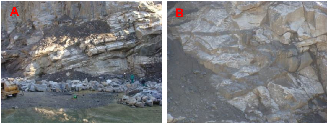
Figura 6 - A- Vista geral do bandamento do mármore na Mineração Mônego em Vila Nova do Sul e - B- dobra em “M deitada” na parede oeste da cava.
