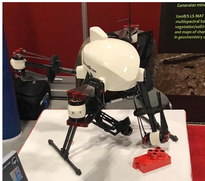
Figura 12 - Drone com sensor multiespectral (objeto vermelho no lado direito do drone).
