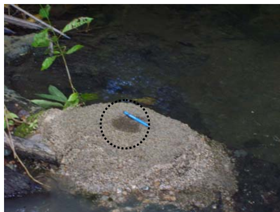
Foto 4 - mostra o pré-concentrado de minerais pesados a ser coletado (círculo), e minerais leves nas bordas.
