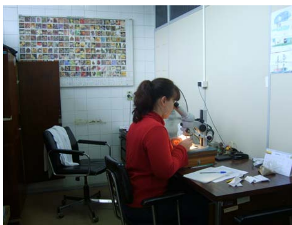
Foto 6 - mostrando analista fazendo uso de lupa binocular para separação e catagem dos minerais de interesse.
