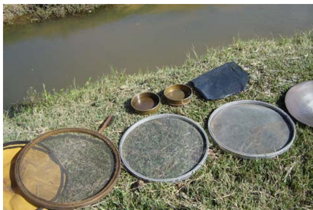
Foto 3 – mostra um kit ideal para pesquisa, usado para obtenção de pré-concentrado de minerais pesados.
