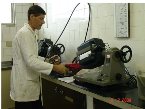
Foto 5 - mostrando separador magnético tipo Frantz usado nos procedimentos de preparação dos concentrados.
