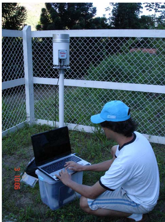
Figura 14 - Estação tipo Pr – Campo de Aventuras Açú – coleta de dados
