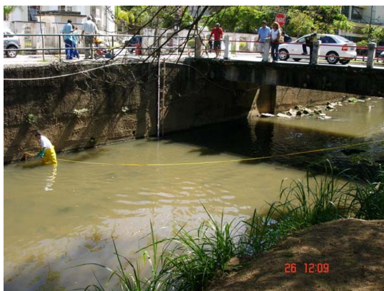
Figura 12 - Estação Liceu tipo PrFrDA, rio Piabanha – tubo do sensor, régua e medição de vazão
