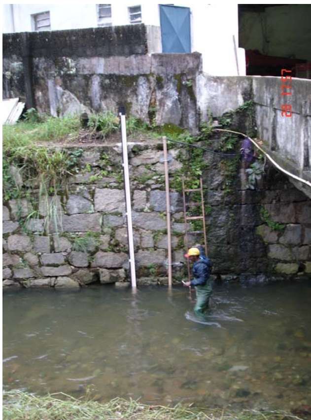
Figura 13 - Estação Morin (Batata), rio Palatinato - vista do tubo do sensor de nível e das régua linimétricas
