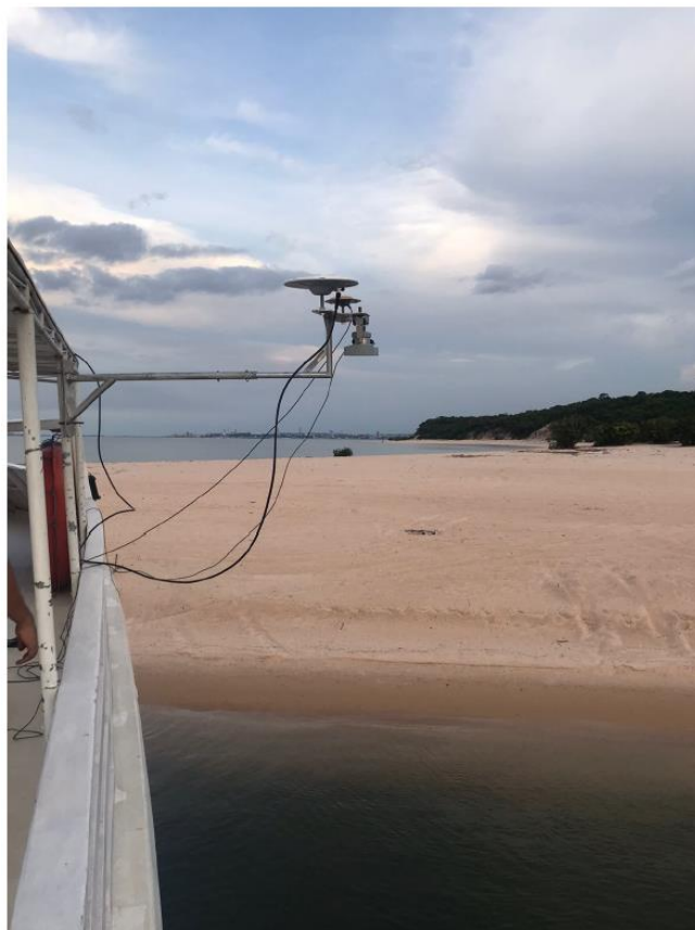
Figura 19 - Receptor GPS e Sensor Radar instalado na embarcação.
