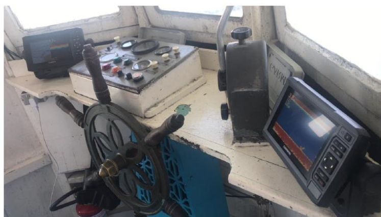
Figura 20 - Telas dos ecobatímetros instalados na embarcação fluvial utilizada para campanha.
