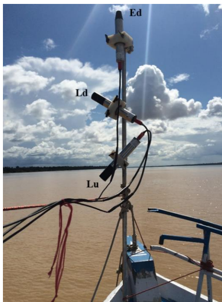
Figura 7 - Conjunto de espectros-radiômetros adquiridos pelo projeto Dinâmica Fluvial.
