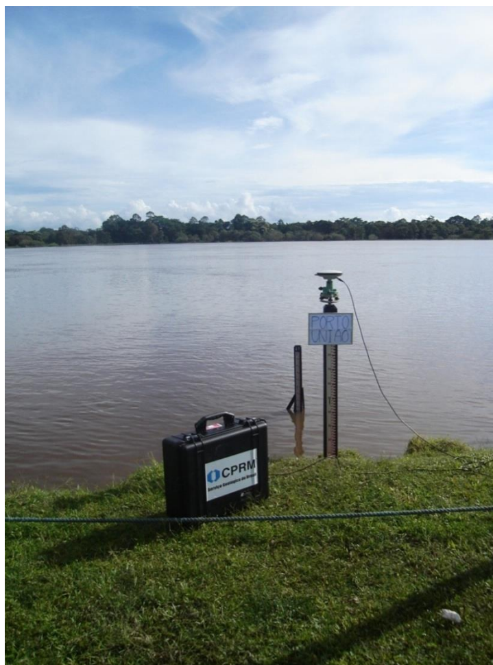
Figura 13 - Ocupação de um lance de régua por receptor GPS para nivelamento da estação fluviométrica de Porto União.
