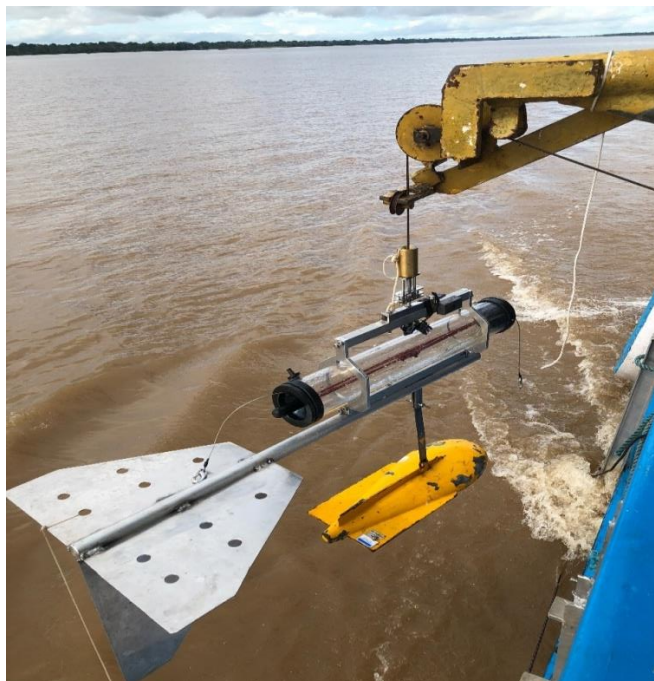
Figura 6 - Amostrador de sedimentos adaptado para Amazônia, desenvolvido por Martinelli-Santini, na parceria CPRM-IRD.
