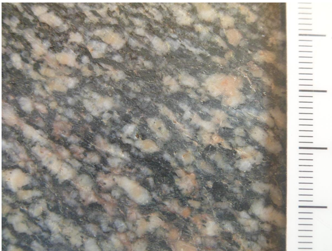
Figura 15: detalhe da foliação tectônica observada no Granito Creporizão (Garimpo Ouro Roxo, testemunho de sondagem, ponto FH-031; foto de Leda Fraga)
