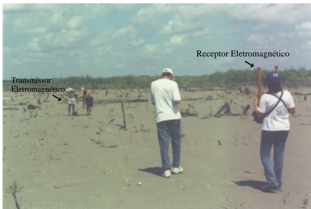
Figura 8- Fotografia mostrando a operação com o método eletromagnético.
