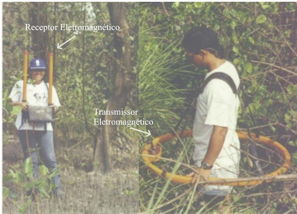
Figura 9 – Fotografia mostrando o transmissor e o receptor eletromagnético.
