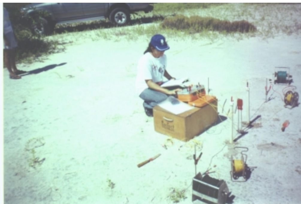
Figura 6- Fotografia mostrando a operação de campo utilizando o arranjo Schlumberger.
