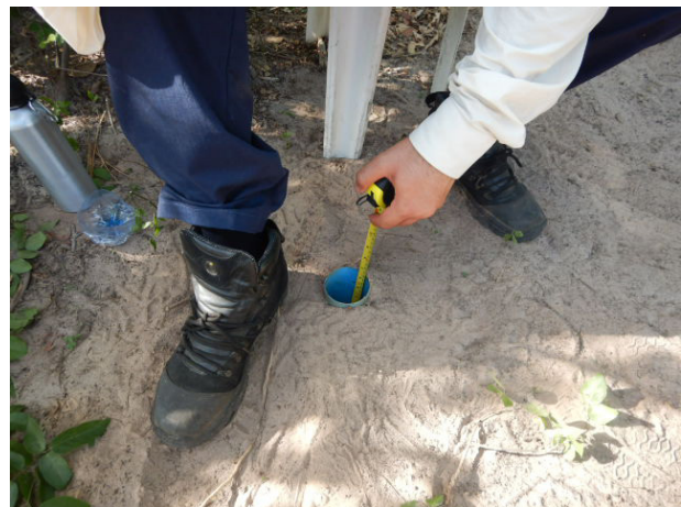
Figura 3.9 - Execução do teste de infiltração realizado no FT-05. Foto: acervo dos autores.
