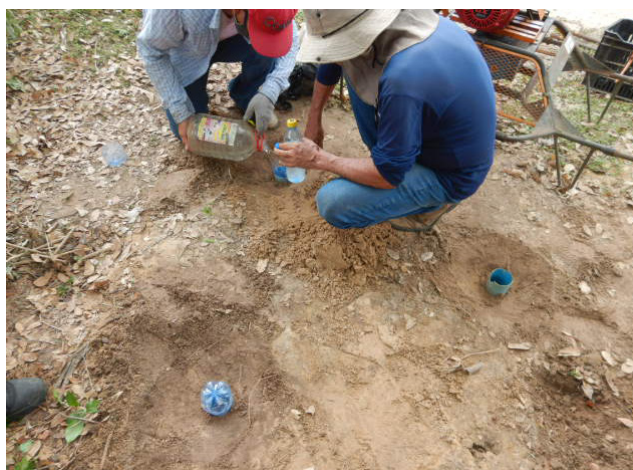
Figura 3.3 - Furos de 0,5 m, 1,0 m e 1,5 m revestidos com tubos de PVC com 75 mm de diâmetro, para serem executados os testes de infiltração. Foto: acervo dos autores.
