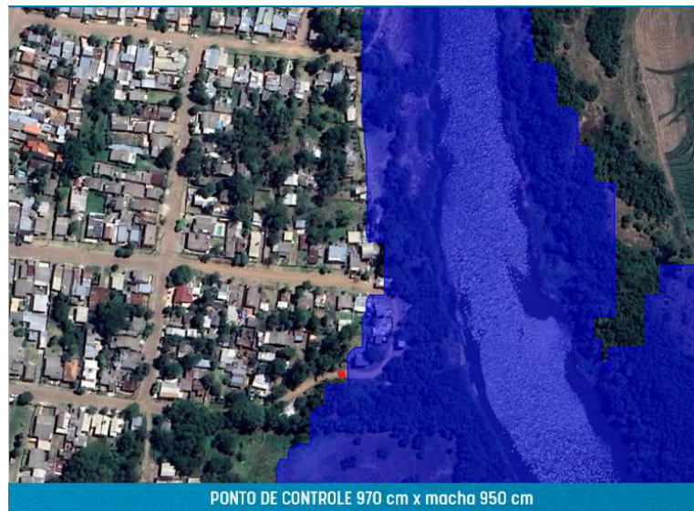
Figura 16: mancha de inundação nível 950 cm x ponto de controle 970 cm.
