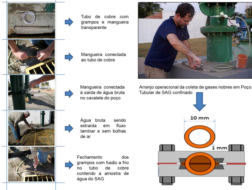
FIGURA 6 – Fluxograma dos procedimentos operacionais para a amostragem de água subterrânea para análise de GN. Extraído de KIRCHHEIM (2021). SAG: Sistema Aquífero Guarani.
