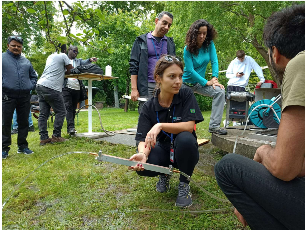
Figura 3 – Treinamento na coleta de amostras utilizando fluxo contínuo em tubo de cobre
