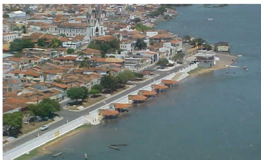
Figura 1 – Área das barracas da “orla da prainha” atingida pelo última cheia com lâmina d'água de 3,8 mts e volume de aproximadamente 5400 m 3 . (Fonte: Mapeamento das Áreas Inundáveis do Rio São Francisco entre Reservatório da UHE de Xingó e a Foz)
