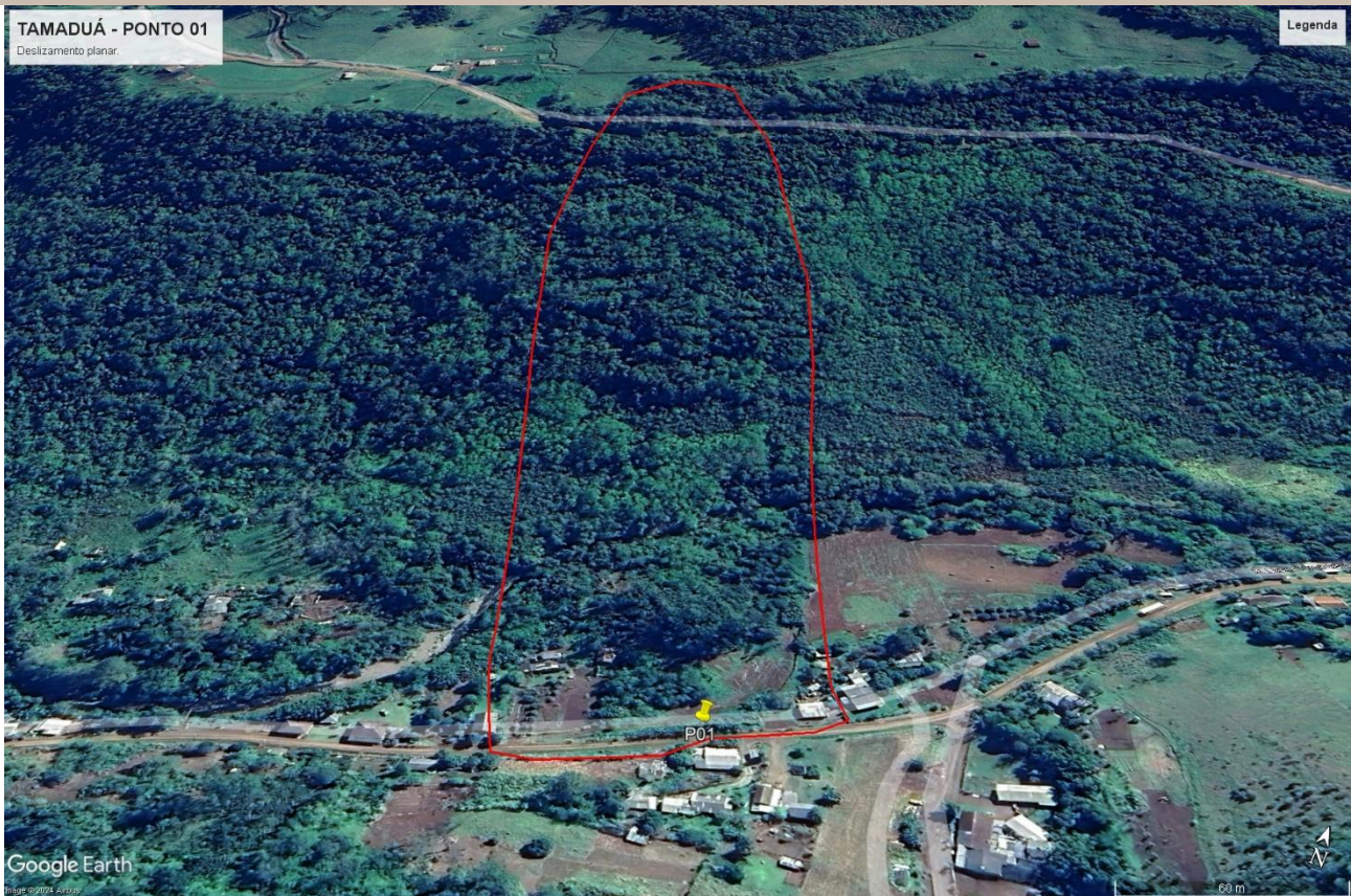
Figura 3– Ponto P01. Delimitação aproximada do deslizamento planar que atingiu diversas casas, em área rural, na Localidade de Tamadué. Imagem Google Earth.
