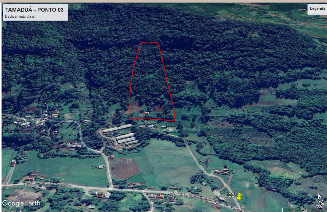
Figura 10– Ponto P03. Delimitação aproximada do deslizamento planar que atingiu quatro casas, em área rural na Lonalidade de Tamadué. Imagem Google Earth.
