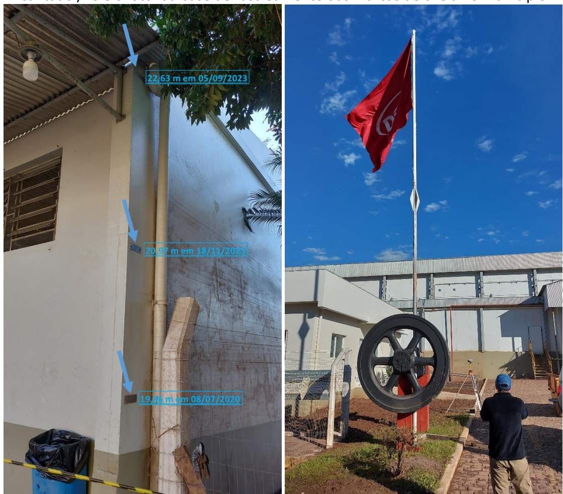
Figura 5. Locais das marcas de cheia de 08/07/2020, 05/09/2023 e 18/11/2023, no frigorífico em Encantado /RS e o local da base de rastreamento das marcas de cheia no município.
