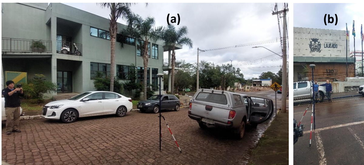
Figura 3. Levantamento com GPS-RTK na cidade de Bom Retiro do Sul (a) e em Lajeado (b).
