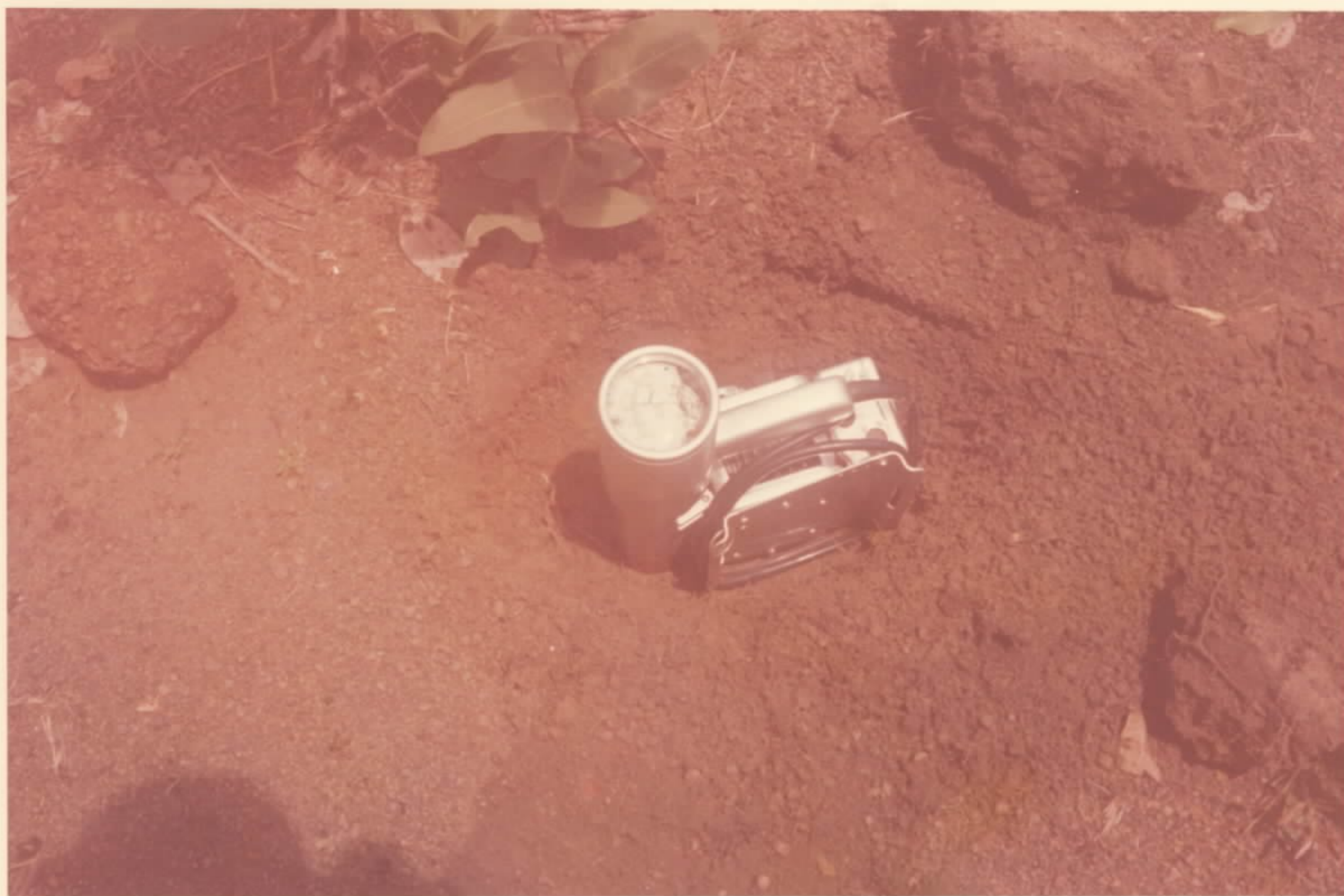
Detalhe da superfície acima, com o cintilômetro mostrando a radiação de 100 cps em superfície.
