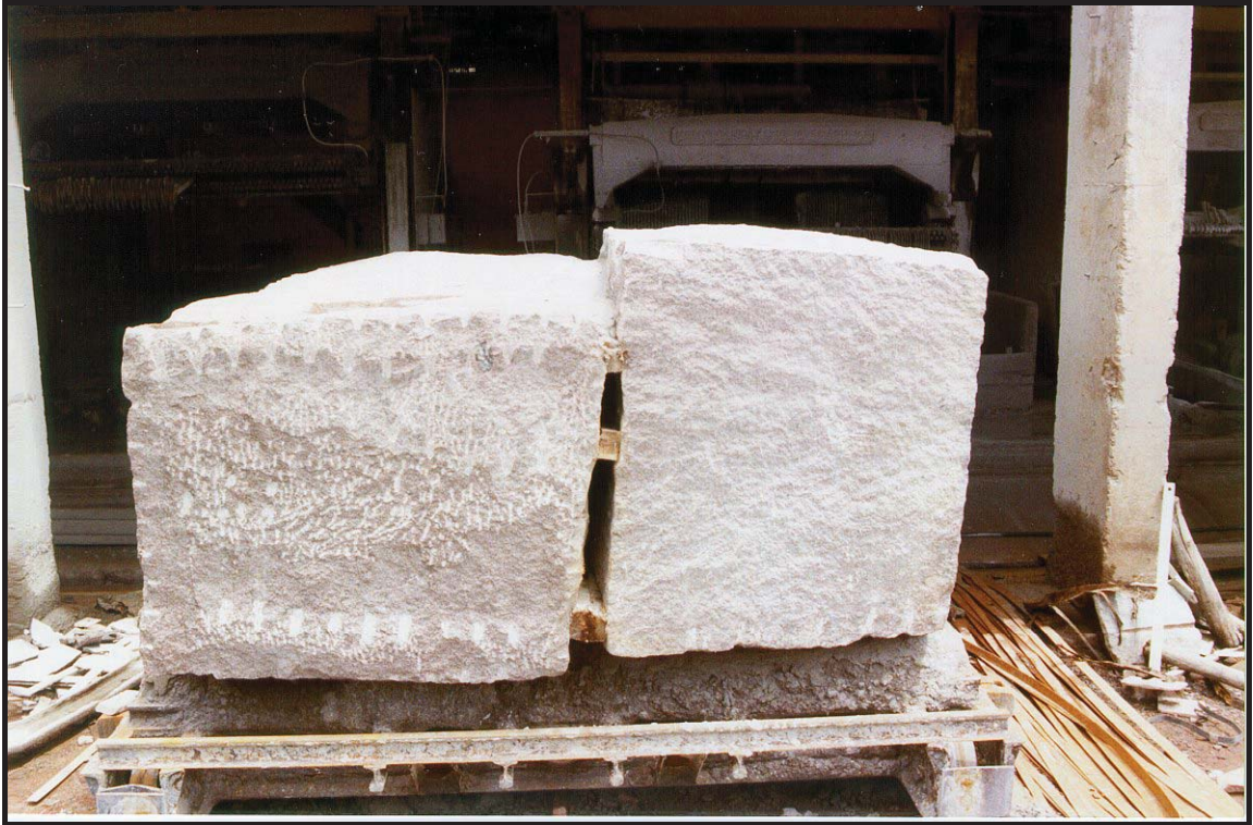
Figura 03 – Blocos de rocha sendo encaminhados para o desdobramento - CIGRAMAR
