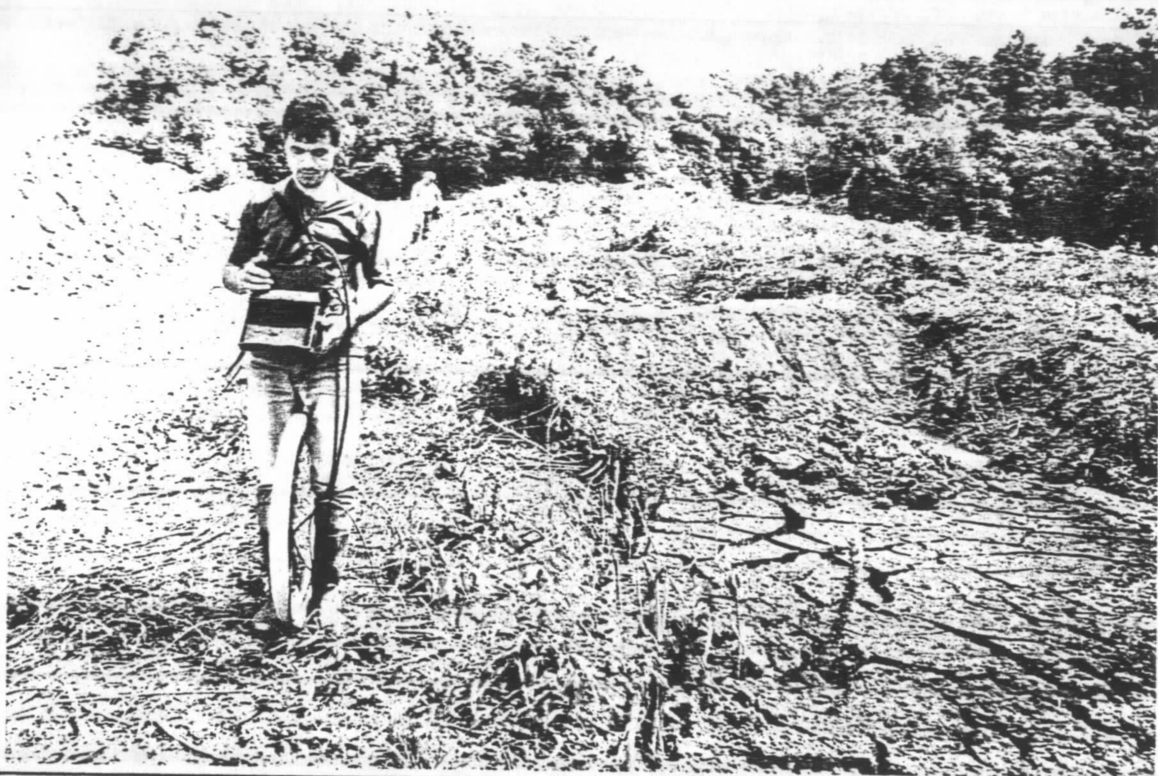
FOTO 3 - Levantamento geofísico com EM34-3
