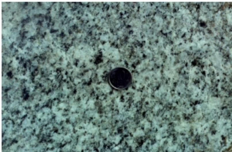
**Foto 2.22** - Granito Wolff discretamente orientado.
