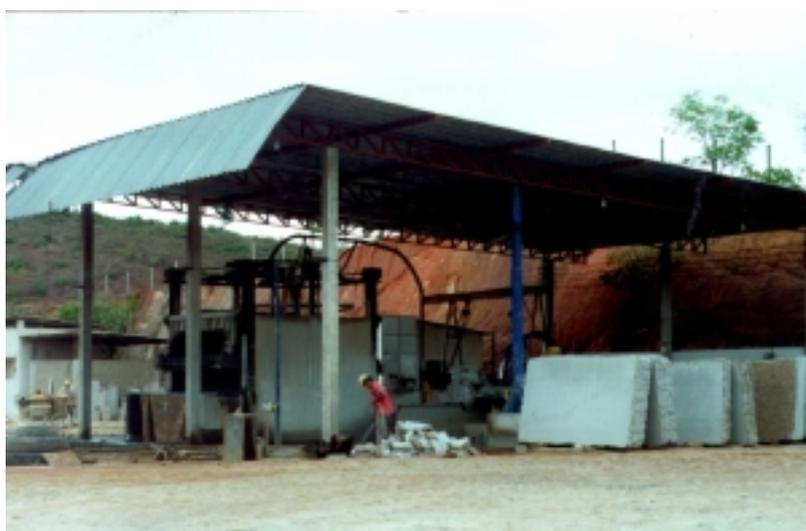
**Foto 4.4** - Tear da Galama SA. para corte de chapas de granito.
