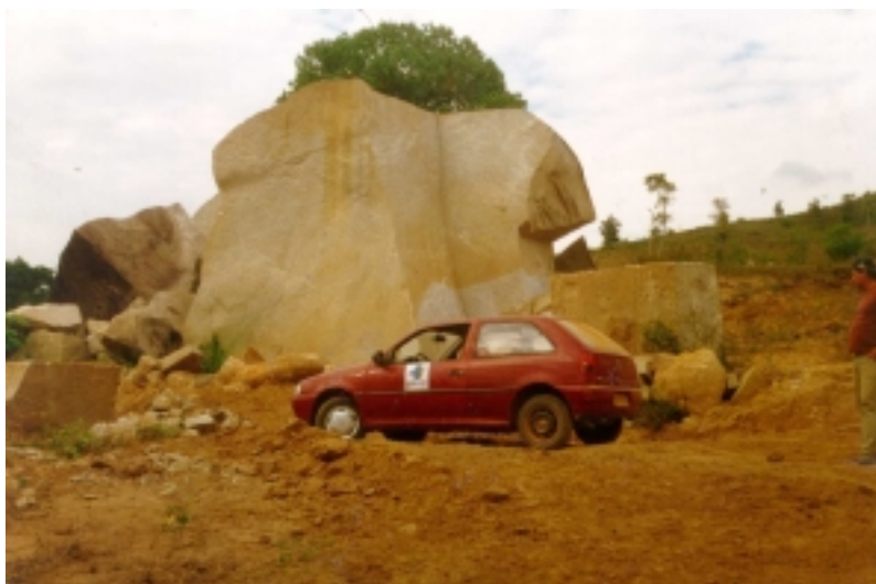
Foto 4.4 - Extração de leucogranito granatífero, serviço em matacões. Oeste de Pavão. Estação: AR-089. UTM: 282905/8073235.
