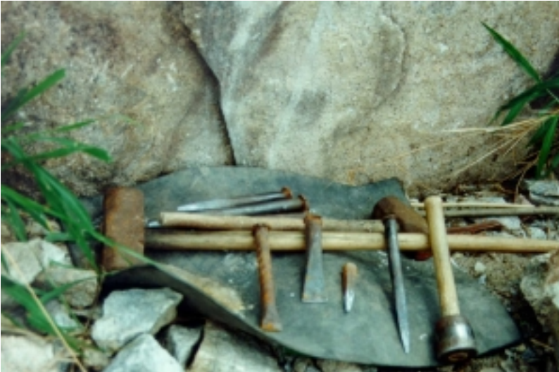
Foto 4.2 - Ferramentas utilizadas na obtenção de paralelepípedos.
